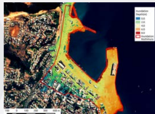
タルカワノ市における2010年地震津波の浸水実績と再現計算の比較
